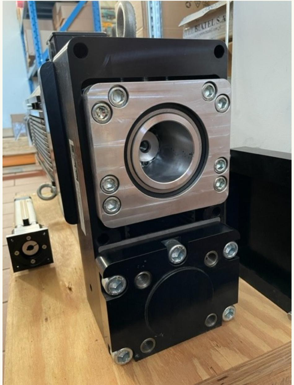
Dodatkowy port smarowania siłownika dostępny do wykonania z każdej strony profilu aby ułatwić prace serwisowe
